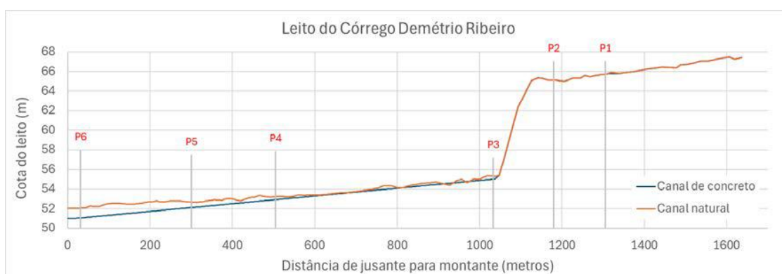
Figura 14. Comparação entre o perfil de fundo original do córrego Demétrio Ribeiro e do perfil proposto para os cenários A e B, ajustado a partir da ponte P3.
