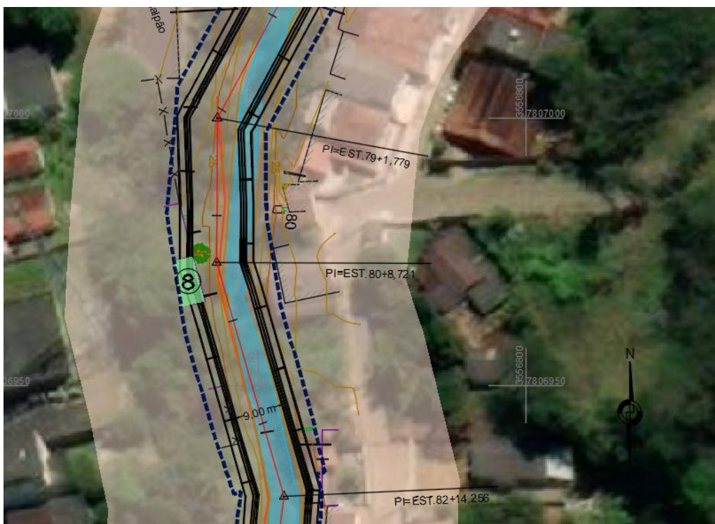
Figura – Edificações a serem desapropriadas nas proximidades da estaca 80.
