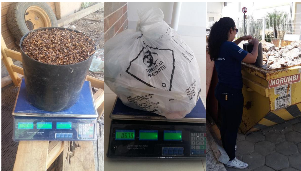
Figura 13 – Medições e estimativas de quantidades de resíduos gerados nos empreendimentos visitados
