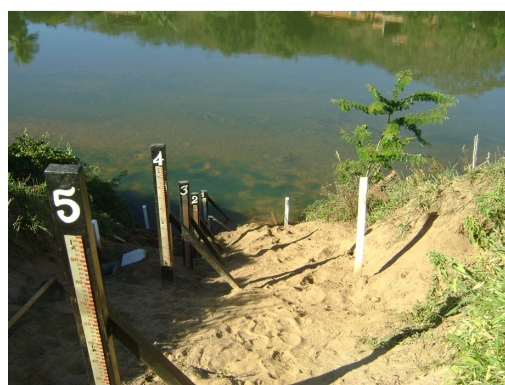
Foto 02 - Seções de réguas linimétricas.
