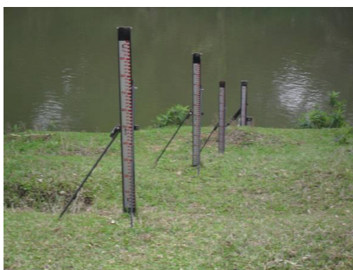
Foto 01 – Seções de réguas linimétricas.
