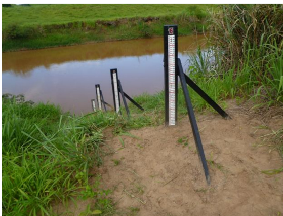
Foto 03 – Apoios nos mourões das réguas linimétricas.
