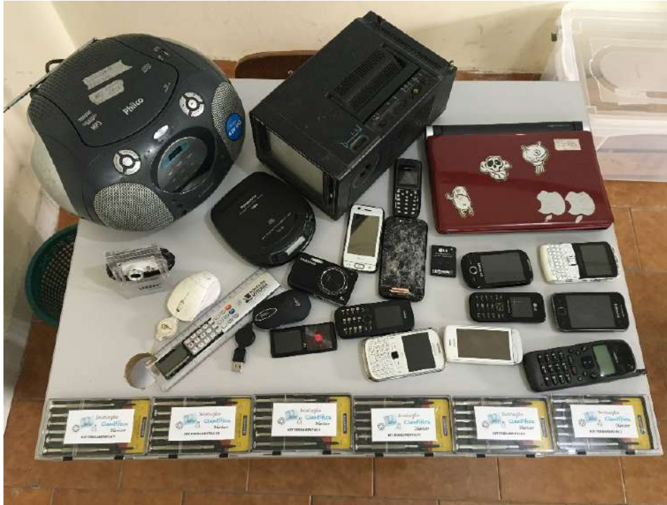
Figura 4 - Resíduos de equipamentos eletroeletrônicos recebidos na “Campanha de descarte correto de lixo eletrônico” e desmontados manualmente.
