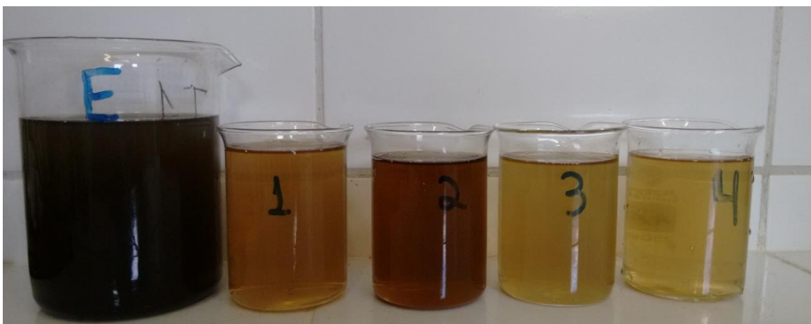
Figura 6 – Amostras coletadas em Dezembro de 2016 para análise do efluente bruto (DIREITA) e dos efluentes tratados (1 a 4)
