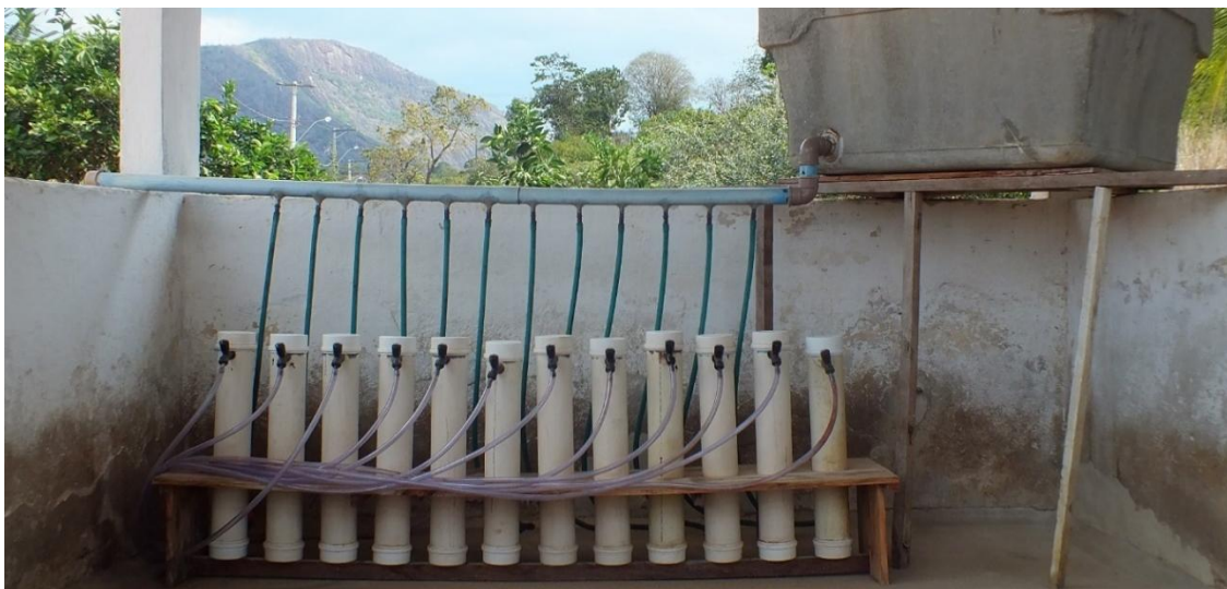
Figura 5 – Filtros anaeróbios utilizados no experimento para o tratamento de águas residuárias da suinocultura do Ifes - campus Santa Teresa - ES
