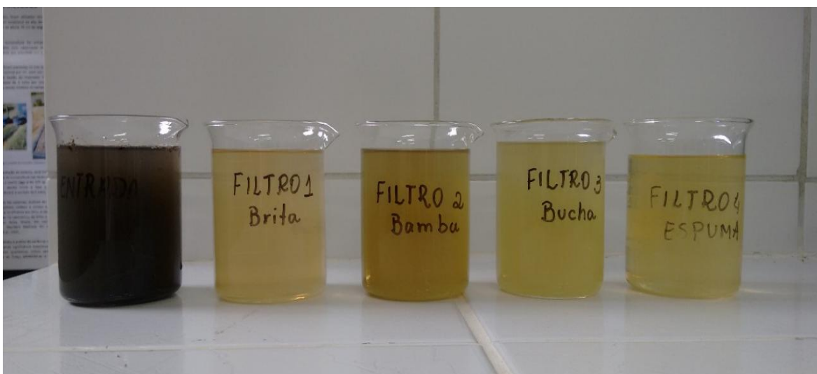
Figura 8 - Amostras coletadas em Abril de 2017 para análises dos efluente bruto (ESQUERDA) e dos efluentes tratados (FILTRO 1, FILTRO 2, FILTRO 3 E FILTRO 4)
