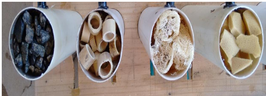
Figura 1 - Vista superior dos filtros contendo diferentes tipos de material suporte: brita, anéis de bambu, bucha vegetal e espuma
