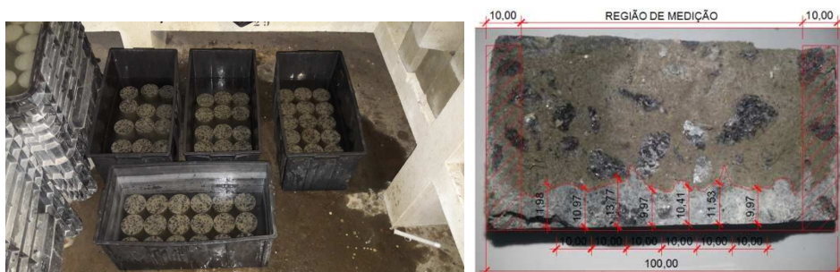
Figura 7. Ensaio de difusão por imersão, fonte: autor
