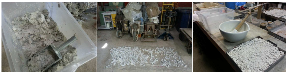
Figura 5. Resíduo recolhido e submetido a secagem natural, Fonte: Autor
