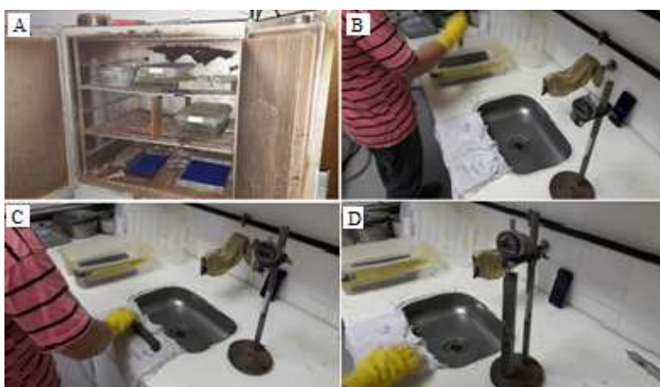
Figura 8. Processo de execução do ensaio de reação álcali-silica (a: amostras em estufa; b: retirada de amostras de solução; c: processo de secagem e d: leitura da expansibilidade), fonte: autor
